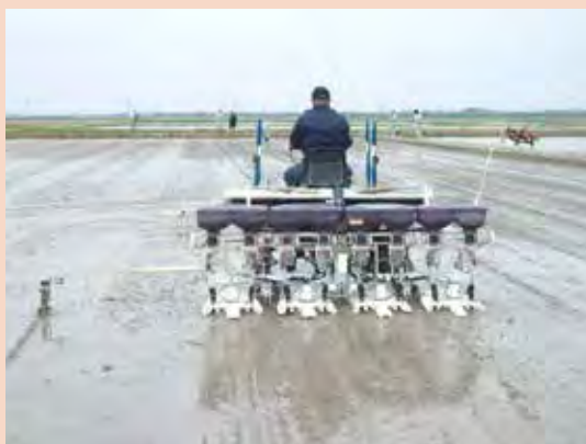
直播栽培（播種機を装着した多目的田植機）
